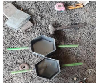
**Gambar 1. Bahan dan alat Eco Pavingblock**      **Gambar 2. Cetakan Hexagonal**
