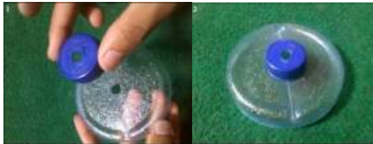
Gambarr 13. Melubangi tutup botol air dan lingkaran toples
