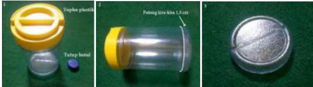
Gambar 12. Potong bagian bawah toples
